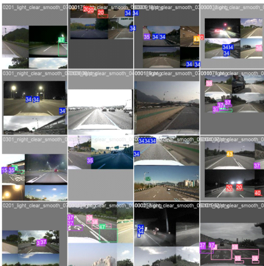
그림 5. 학습 데이터의 Mosaic 증강 예시 Fig. 5. Example of mosaic augmentation for training data
